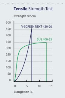
der Schablone während des Druckprozesses. Physikalisch wird diese Spannungs-Dehnungs-Kurve mit der Zugfestigkeitsmethode geprüft.
